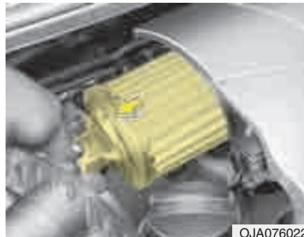
2. Протрите шланг воздушного фильтра внутри.
