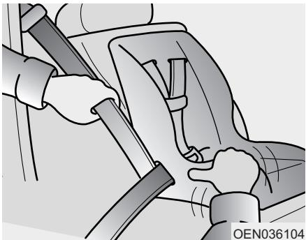
Для снятия детской системы безопасности следует нажать кнопку на пряжке ремня безопасности, извлечь ремень с креплением в трех точках из крепления детской удерживающей системы и дать ремню безопасности полностью втянуться.
