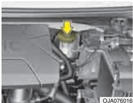
Периодически проверяйте уровень жидкости в бачке. Уровень должен быть между отметками MIN и MAX на боковой поверхности бачка.
