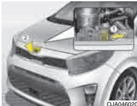
2. Встаньте перед автомобилем, приподнимите капот, нажмите на дополнительную защелку (1), расположенную по центру с внутренней стороны крышки капота и поднимите капот (2).
