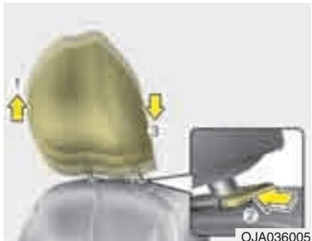
Для того, чтобы поднять подголовник, потяните его вверх до требуемого положения (1). Для того, чтобы опустить подголовник, нажмите кнопку фиксатора (2) на опоре подголовника и удерживайте ее в нажатом положении, опуская подголовник в требуемое положение (3).
