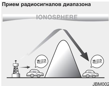
Сигнал AM передается на большее расстояние, чем сигнал FM. Это происходит потому, что радиоволны AM диапазона передаются на низких частотах. Эти длинные, низкие радиочастотные волны могут огибать Землю, а не распространяться по прямой в атмосфере. Кроме того они огибают препятствия и поэтому обеспечивают лучшее покрытие сигнала.
