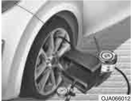
Система Tire Mobility Kit позволяет не менять колесо при образовании прокола в шине.
