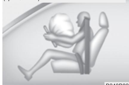
Модули подушек безопасности находятся в центре рулевого колеса и внутри передней панели напротив пассажирского сиденья над перчаточным ящиком. Когда блок SRSM определит наличие удара большой силы в переднюю часть автомобиля, он автоматически подаст команду на раскрытие подушек безопасности.
