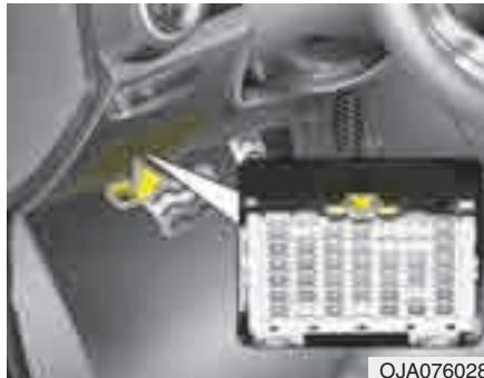
Автомобиль оснащен предохранителем, позволяющим предотвратить разряд аккумуляторной батареи в случае стоянки с выключенным двигателем в течение длительного периода времени. Перед постановкой автомобиля на стоянку на продолжительное время выполните следующие действия.
