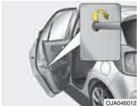
Специальное устройство блокировки замков задних дверей предназначено для предотвращения их случайного открывания детьми, находящимися внутри автомобиля. Это устройство необходимо использовать всегда при нахождении детей в автомобиле.
