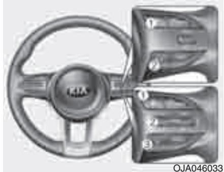
Режимы окна ЖК-дисплея можно изменить с помощью кнопок управления на рулевом колесе.
