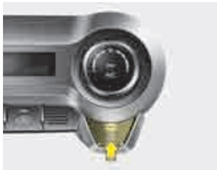
Обогреватель заднего окна автоматически отключается после приблизительно 20 минут работы или при переводе ключа зажигания в положение "OFF" (Выкл.). Для выключения обогревателя нажмите на кнопку его включения еще раз.
