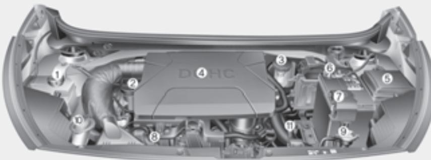
1. Бачок для охлаждающей жидкости двигателя .....8-36
