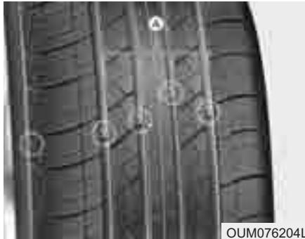
Если шина изношена равномерно, то индикатор износа появится (А) в виде сплошной полосы, расположенной поперек протектора. Это означает, что нашине остался слой протектора толщиной менее 1,6 мм (1/16 дюйма). Если это произошло, замените шину.
