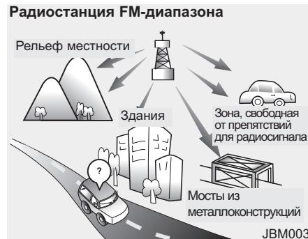
FM сигнал передается на высоких частотах и не искривляется, проходя вдоль поверхности Земли. Поэтому FM сигнал обычно начинает затухать на коротком расстоянии от радиопередающей станции. Кроме того FM сигналы легко нарушаются зданиями, горами и другими препятствиями. Это может привести к определенным состояниям при воспроизведении звука, которые могут выглядеть как неисправность радио. Указанные ниже состояния являются нормальными и не указывают на неисправность радио.
