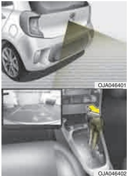
Данная система является вспомогательной и предназначена для вывода изображения обстановки позади двигающегося задним ходом автомобиля на монитор навигационной системы.
