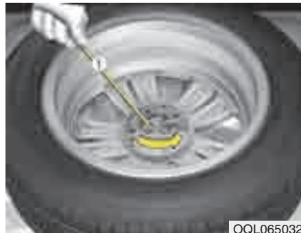
Вращать против часовой стрелки винт-барашек крепления колеса.
