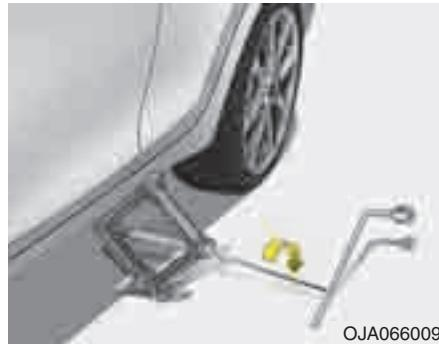
8. Вставив рукоятку домкрата и поворачивая ее по часовой стрелке, поднимайте автомобиль до тех пор, пока колесо не оторвется от земли. Это расстояние составляет примерно 30 мм (1,2 дюйма). Перед тем как откручивать колесные гайки, убедитесь в устойчивости автомобиля и в отсутствии возможностей его передвижения или скользы-вания.
