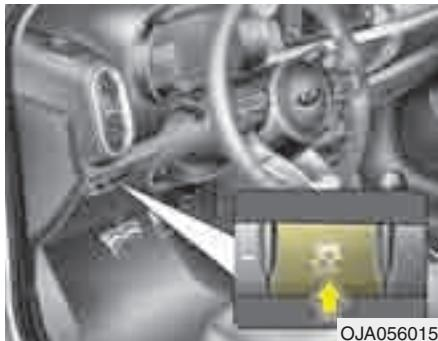
Электронная система динамической стабилизации (ESC) предназначена для обеспечения устойчивости автомобиля при движении на повороте. ESC проверяет направление, задаваемое рулевым управлением, и фактическое направление движения автомобиля. ESC притормаживает отдельные колеса и воздействует на систему управления двигателем, чтобы стабилизировать автомобиль.
