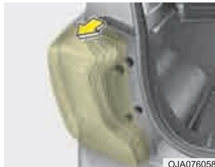
3. Извлеките узел задней комбинированной фары из кузова автомобиля.
