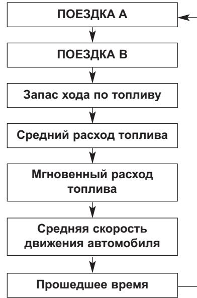
Изменить режим движения можно с помощью переключателя прокрутки ( $\leftarrow/\rightarrow$ ) или кнопки «TRIP» (Информация о поездке) в режиме маршрутного компьютера.
