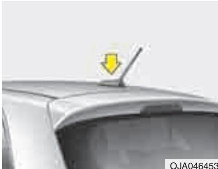
Внешняя антенна автомобиля предназначена для приёма радиосигналов в АМ-диапазоне и в FM-диапазоне. Эта антенна - съемного типа. Для снятия поверните ее против часовой стрелки. Для установки поверните ее по часовой стрелке.
