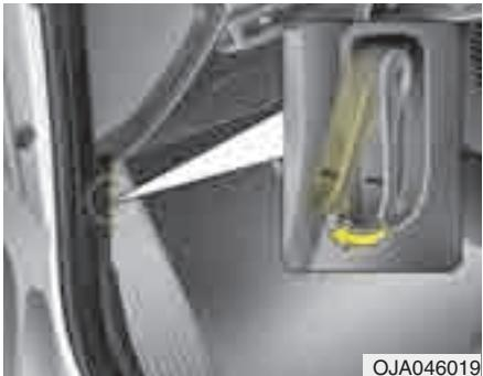
1. Потяните за ручку открывания капота для разблокировки его замка. Капот должен немного приоткрыться.
