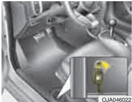
Крышка горловины топливного бака открывается изнутри автомобиля путем вытягивания отпирателя горловины топливного бака, расположенного в передней напольной зоне сиденья водителя.
