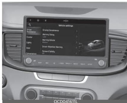
Informacijos ir pramogų sistemos automobilio nuostatų meniu galima rasti įvairių parametru parinktis, išskaitant durų užrakinimo / atrakinimo bei komforto funkcijas, vairuotojo pagalbos sistemos nuostatas ir pan.
