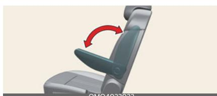
Regulējams rokas balsts atrodas abās otrās rindas sēdekļa pusēs. Lai izmantotu rokas balstu, pavelciet to uz priekšu no sēdekļa atzveltnes un noregulējiet to vēlamajā leņķi. Pavelciet rokas balstu uz aizmuguri, lai to pārvietotu.
