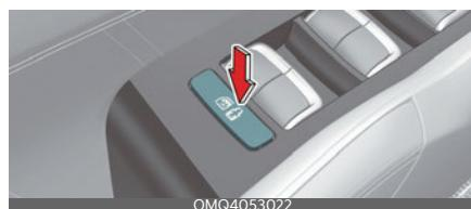
Ja elektroniskā bērnu drošības slēdža poga atrodas pozīcijā LOCK (bloķēts) un tiek atpazīts transportlīdzeklis, kas tuvojas no aizmugures, elektroniskā bērnu drošības slēdža poga () neatbloķējas pat tad, ja vadītājs nospiež pogu, lai novērstu aizmugurējo durvju atvēršanos.
