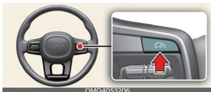
Lai izslēgtu manuālās ātruma ierobežošanas palīgsistēmu, nospiediet braukšanas palīgsistēmas pogu (a). Ātruma ierobežojuma indikators (LIMIT) nodzīest.
