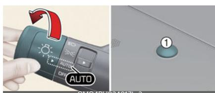
Ja lukturu slēdzis atrodas automātiskās ieslēgšanas pozīcijā (AUTO), priekšējie lukturi tiek automātiski ieslēgti un izslēgti atkarībā no apgaismojuma automobiļa ārpusē.
