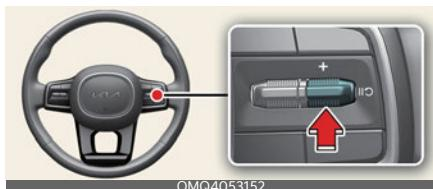
Nospiediet slēdzi (II), lai īslaicīgi apturētu iestatīto ātruma ierobežojumu. Iestatītais ātruma ierobežojums tiek izslēgts, taču ātruma ierobežojuma indikators (LIMIT) paliek ieslēgts.
