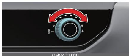
Lai nomainītu temperatūru pasažieru nodalījumā, pagrieziet pogu pa labi, lai ieplūstu siltāks gaisss, vai pa kreisi, lai ieplūstu vēsāks gaisss.
