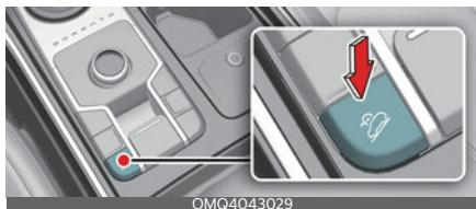
Nogāzes bremžu vadības (Downhill Brake Control — DBC) funkcija palīdz vadītājam nobraukt pa stāvu nogāzi, nenospiežot bremžu pedāli.
