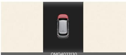
Brīdinājuma signāls tiks ieslēgts, ja automobilis pārvietojas ar ātrumu 3 km/h (2 jūdzes stundā) ar atvērtu pārsegu.
