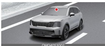
Priekšējā skata kamera tiek izmantota kā uztveršanas sensors, lai automobiļa vadišanas laikā palīdzētu noteiktu braukšanas stāvokli un priekšā esošā automobiļa kustības uzsākšanu. Uztveršanas sensora konkrēto atrašanās vietu skatiet iepriekšējā attēlā.
