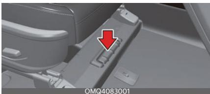
Numurs ir štancēts uz grīdas zem priekšējā labās puses sēdekļa. Lai pārbaudītu numuru, atveriet pārsegu.
