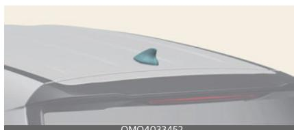
Haizivs spuras antena uztvers pārraidītos datus. (piemēram, GPS)
