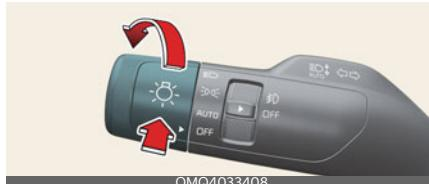
Tālo gaismu palīgsistēma ir funkcija, kas automātiski pielāgo priekšējo lukturu diapazonu (pārslēdz starp tālajām un tuvajām gaismām) atkarībā no konstatēto transportlīdzekļu spilgtuma un konkrētajiem apstākļiem uz ceļa.
