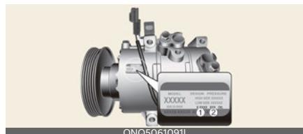
Kompresora markējums ietver informāciju par kompresoru, kas uzstādīts jūsu automobilī, piemēram, modeļi, piegādātāja detaļas numuru, ražošanas numuru, dzesētāju (1) un dzesētāja eļļu (2).
