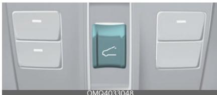
Jumta lūku var izmantot tikai tad, ja aizdedzes atslēga vai ENGINE START/STOP poga ir ieslēgta vai atrodas pozīcijā START.
