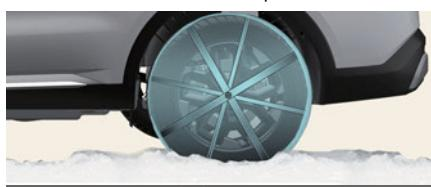
Tā kā radiālo riepu sānu sienīnjas ir plānākas, tās iespējams sabojāt, uz tām uzstādot riepu kēdes. Tādēļ ieteicams riepu kēžu vietā lietot ziemas riepas. Neuzstādiet riepu kēdes automobilijiem,
