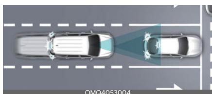
Priekšējās sadursmes novēršanas palīgsistēma konstatē priekšā uz ceļa esošu automobili, motociklu vai mopēdu, gājēju vai velosipēdistu un var brīdināt par iespējamu sadursmi ar brīdinājuma paziņojumu uz instrumentu paneļa un brīdinājuma skaņas signālu. Tāpat priekšējās sadursmes novēršanas palīgsistēma var palīdzēt automobila bremzēšanā, lai palīdzētu samazināt sadursmes ātrumu vai izvairīties no sadursmes.
