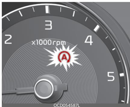
Для индикации работы системы ISG используется лампа на приборной панели. Если автомобиль оснащен приборной панелью, на ЖК-дисплее отобразится примечание.
