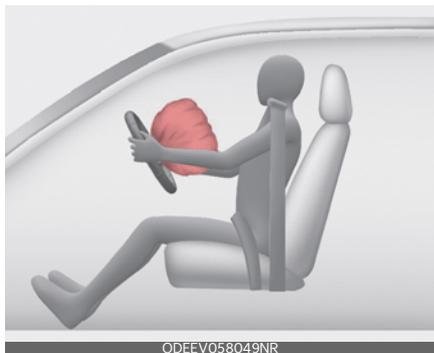
Когда срабатывают подушки безопасности, под давлением от их разворачивания отделяются отрывные швы в предохранительных крышках. После открывания крышки подушка безопасности полностью надувается.
