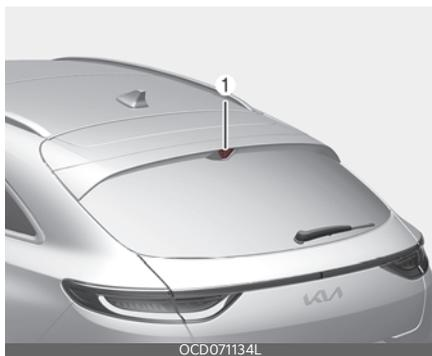
Если лампа дополнительного верхнего стоп-сигнала (светодиодная) (1) не работает, следует проверить автомобиль в специализированной мастерской.
