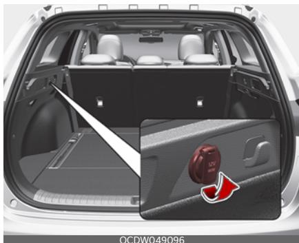
Розетка предназначена для подключения мобильных телефонов и других электроприборов, рассчитанных на питание от автомобильной электро-системы. Эти устройства должны потреблять ток не более 15 А при включенном двигателе.
