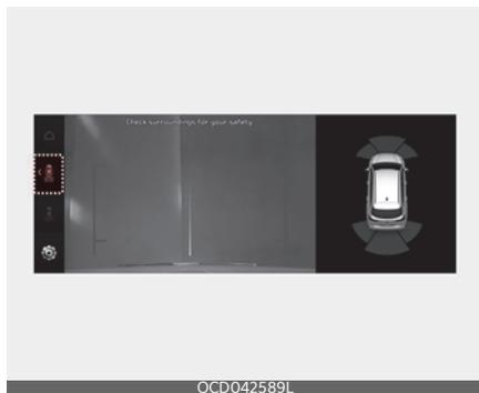
При нажатии значка (
