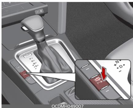
Нажмите кнопку Безопасная парковка (P) (▲). Нажмите кнопку еще раз, чтобы отключить систему предупреждения о расстоянии при парковке передним/задним ходом. Чтобы выключить функцию, нажмите кнопку еще раз.
