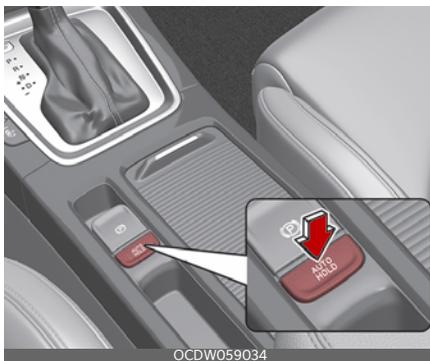
1. Закройте дверь водителя, капот и дверь багажного отделения, пристегните ремень безопасности или выжмите педаль тормоза, после чего нажмите кнопку Auto Hold (Автоматическое удержание). Загорится белый индикатор «AUTO HOLD» (Автоматическое удержание) и система перейдет в режим ожидания.
