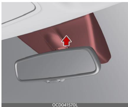
Автоматическая система устранения запотевания снижает возможность запотевания внутренней поверхности лобового стекла, автоматически определяя наличие влаги и увеличивая поток воздуха по направлению к лобовому стеклу.
