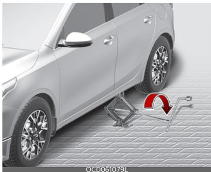
9. Ослабьте гайки колеса и снимите их пальцами. Снимите колесо со шпилек и положите его плашмя на землю, чтобы оно не укатилось. Чтобы установить запасное колесо, совместите отверстия в диске со шпильками и посадите на них колесо.
