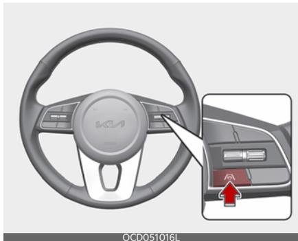
Чтобы включить систему слежения за полосой движения, при работающем двигателе нажмите кнопку «Lane Driving Assist» (Автоматическое удержание на полосе) на рулевом колесе. На приборной панели (🚦) загорается на приборной панели.
