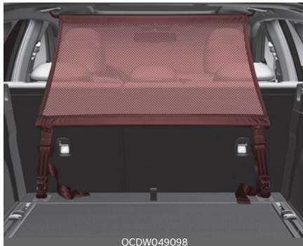
Она предназначена для защиты голов пассажиров, предотвращая перемещение вещей вперед при лобовом столкновении.
