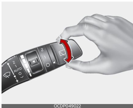
Переключатель стеклоочистителя и стеклоомывателя заднего стекла расположен на конце рычага с переключателем стеклоочистителя и стеклоомывателя. Поверните переключатель в требуемое положение для работы заднего стеклоочистителя и стеклоомывателя.
