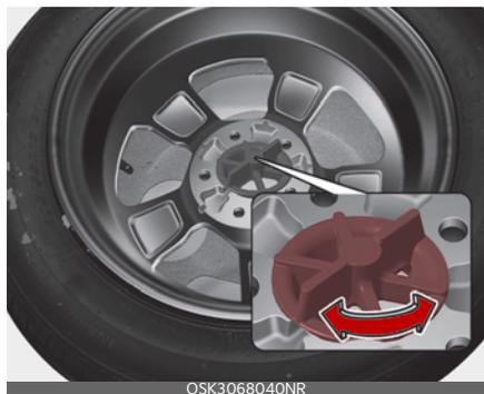
Для снятия колеса поверните болт крепления шины против часовой стрелки. Закрепление для хранения выполняется в порядке, обратном снятию.
