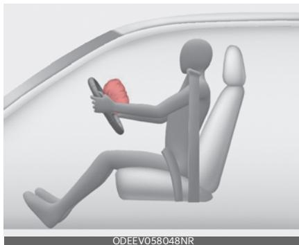
Модули подушек безопасности располагаются по центру рулевого колеса и в передней панели над перчаточным ящиком, напротив пассажира. Если модуль SRSCM регистрирует сильный удар в переднюю часть автомобиля, то автоматически срабатывают подушки безопасности.
