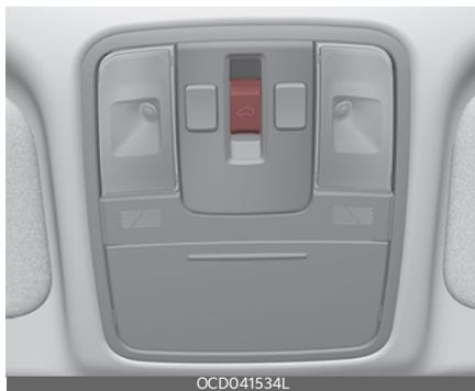
Люком можно управлять только тогда, когда переключатель зажигания или кнопка «ENGINE START/STOP» (Запуск/Остановка двигателя) находится в положении «ON» (Вкл.) или «START» (Запуск).
