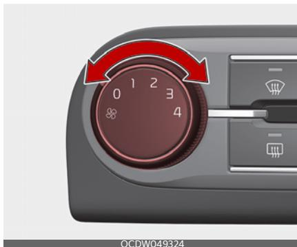
Регулятор скорости вентилятора позволяет регулировать скорость потока воздуха из системы вентиляции.
