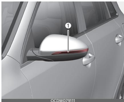
Если боковой повторитель указателя поворота (светодиодный) не работает, следует проверить автомобиль в специализированной мастерской.
