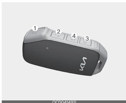
С помощью интеллектуального ключа можно запереть или отпереть любую дверь (в том числе дверь багажного отделения) и даже запустить двигатель, не вставляя ключ в замок зажигания.
