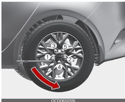
6. Ослабьте каждую гайку колеса на один оборот против часовой стрелки, но не снимайте их, пока колесо не будет поднято над землей.
