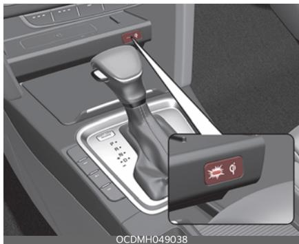
Аккуратно закройте все двери и поверните ключ зажигания в положение «ACC» или «IGN ON». Чтобы начать процесс беспроводной зарядки, поместите смартфон с функцией беспроводной зарядки на панель беспроводной зарядки.
