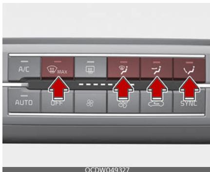
Кнопка выбора режима управляет направлением потока воздуха через вентиляционную систему.
