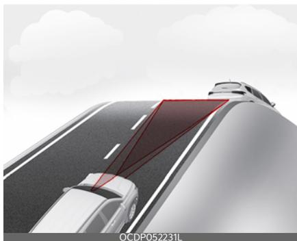
При движении на подъеме или спуске система интеллектуального круиз-контроля может не обнаружить транспортное средство, движущееся в вашей полосе, и ускорит движение до заданной скорости. Кроме того, при неожиданном обнаружении движущегося впереди автомобиля скорость начнет резко снижаться.
