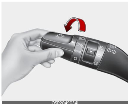
Когда переключатель освещения находится в положении работы стояночных огней (вторая позиция), то работают задние габаритные огни, фонарь освещения номерного знака и подсветка приборной панели.
