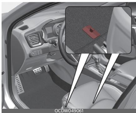
При использовании напольного коврика на напольном покрытии под передним креслом закрепите его при помощи специального (-ых) фиксатора (-ов). Это позволит предотвратить соскальзывание коврика вперед.
