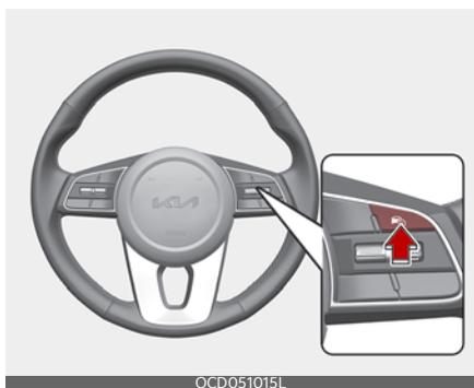
Чтобы отключить систему ручного контроля за ограничениями скорости, нажмите кнопку «Помощь при вождении». Индикатор ограничения скорости погаснет. Всегда нажимайте кнопку «Помощь при вождении», чтобы отключить систему ручного контроля за ограничениями скорости, когда она не используется.
