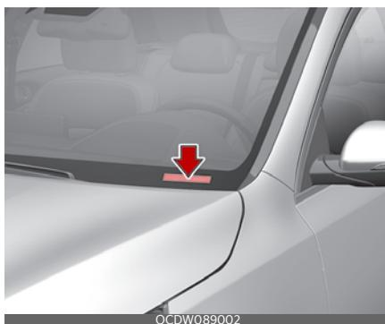
Номер VIN также указан на табличке, прикрепленной к верхней части приборной панели. Номер, нанесенный на табличку, виден снаружи через ветровое стекло.
