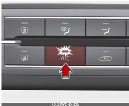
Нажмите кнопку A/C (кондиционер), чтобы включить систему кондиционирования (загорится индикаторная лампа).
