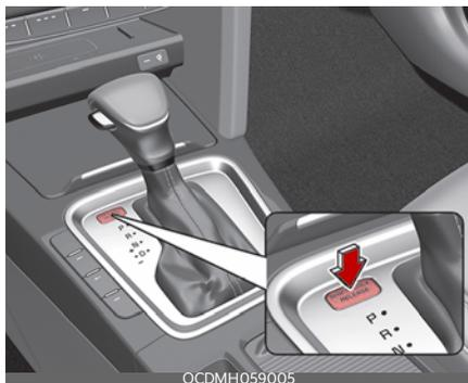
Если рычаг переключения передач невозможно переместить из положения «Р» (парковка) в положение «R» (задний ход) при нажатой педали тормоза, продолжайте нажимать на тор-
