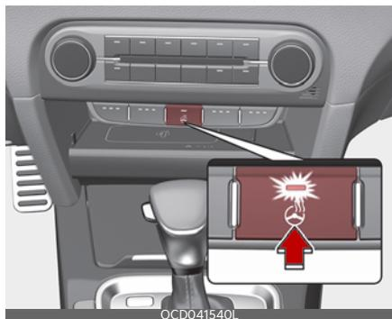
Когда ключ зажигания или кнопка «ENGINE START/STOP» (запуска/остановки двигателя) находится в положении «ON» (Вкл.), нажмите кнопку подогрева рулевого колеса, чтобы сделать его теплее. Индикатор на кнопке загорится.
