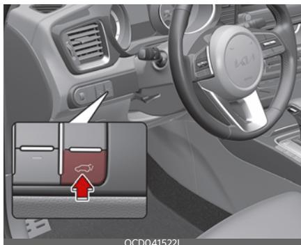
1. Кнопка открытия/закрытия двери багажного отделения с электроприводом
