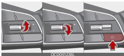
Нажмите переключатель +, - или кнопку || ↻. Если нажать переключатель вверх + или вниз -, система установит скорость движения, указанную
