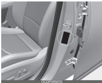
На сертификационной табличке автомобиля (которая находится на средней стойке со стороны водителя или пассажира) указан идентификационный номер автомобиля (VIN).
