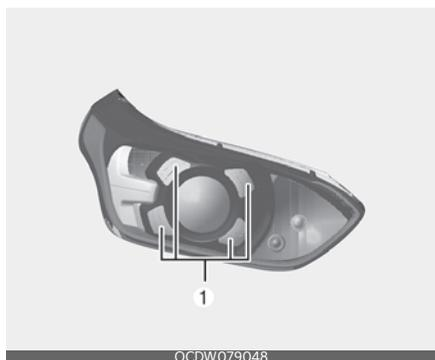
Если лампа габаритных и дневных ходовых огней (светодиодные) (1) не работает, следует проверить автомобиль в специализированной мастерской.
