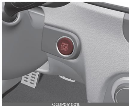
Кнопка «ENGINE START/STOP» (Запуск/остановка двигателя) подсвечивается при каждом открывании передней двери. Подсветка гаснет примерно через 30 секунд после закрывания двери. Она также гаснет сразу же при срабатывании системы противоугонной сигнализации.
