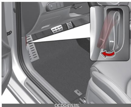
1. Потяните за рычаг, чтобы разблокировать капот. Капот должен слегка приподняться.
