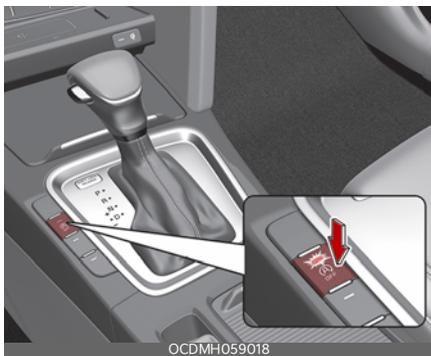
Если вы хотите отключить систему ISG, нажмите кнопку «ISG OFF» (ISG выкл.). Загорается индикатор на кнопке выключения системы ISG
