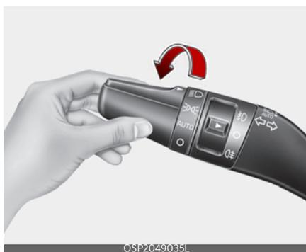
Когда переключатель освещения находится в положении работы передних фар (третья позиция), то горят передние фары, задние габаритные огни, фонарь освещения номерного знака и лампа подсветки приборной панели.
