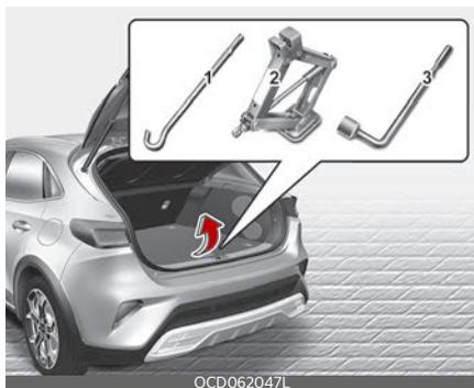
Домкрат, рукоятка домкрата и колесный гаечный ключ хранятся в багажном отсеке.
