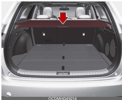
С помощью защитного экрана для груза можно закрыть вещи, которые находятся в багажнике.
