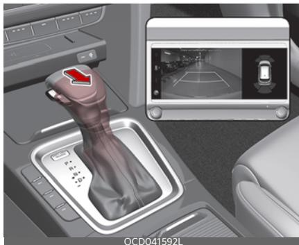
Камера заднего вида отображает область позади автомобиля для помощи при выполнении маневра парковки и движении задним ходом.
