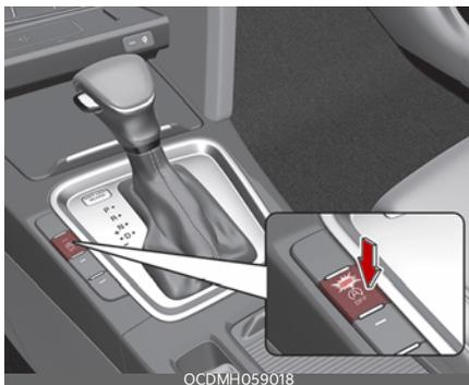
Двигатель не запустится, если при автоматическом останове двигателя рычаг переключения передач был перемещен из положения «N» (Нейтраль) в положение «D» (Передний ход), ручной режим или «R» (Задний ход), и при этом не была нажата педаль тормоза. Если на этом этапе нажать педаль тормоза, двигатель будет повторно запущен.
