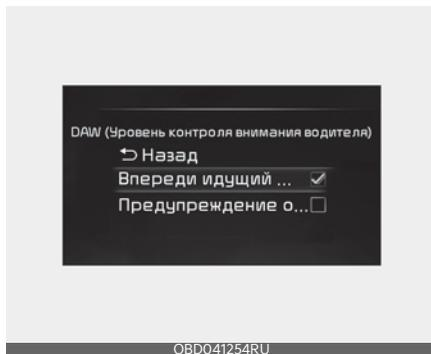
Когда автомобиль включен, выберите **Настройки** → «Помощь водителю» → «Система контроля внимания водителя» на комбинации приборов или **Настройки** → **Автомобиль** → **Помощь водителю** → **Система контроля внимания водителя** → **Контроль отъезда впереди стоящего автомобиля** на экране
