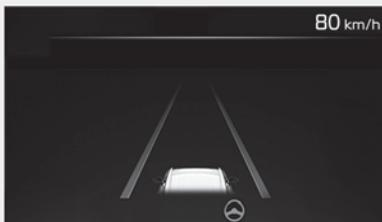
При обнаружении впереди идущего автомобиля и/или обеих разметок полосы движения, а также скорости движения ниже 180 км/ч (110 миль/ч), на приборной панели загорится зеленый индикатор (🚦), и система слежения за полосой движения будет помогать рулевому колесу удерживать автомобиль посередине полосы.
