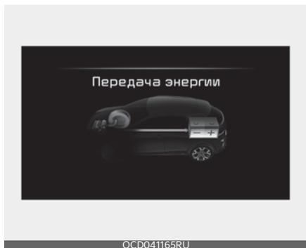
Двигатель и регенеративная тормозная система заряжают высоковольтный аккумулятор.
