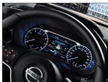
Улучшенный дисплей Advanced Drive Assist (ADAD) с диагональю 7,0 дюйма на панели инструментов
