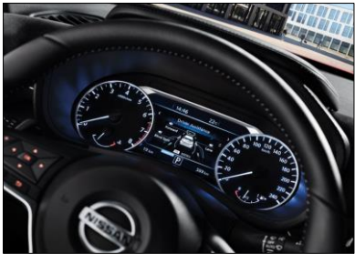
Улучшенный дисплей Advanced Drive Assist (ADAD) с диагональю 7,0 дюйма на панели инструментов
