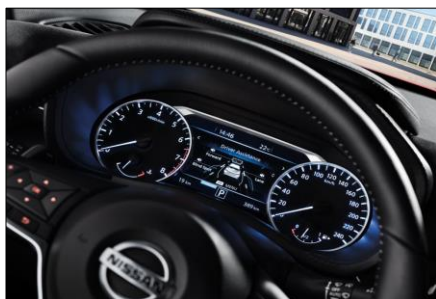
Улучшенный дисплей Advanced Drive Assist (ADAD) с диагональю 7,0 дюйма на панели инструментов
