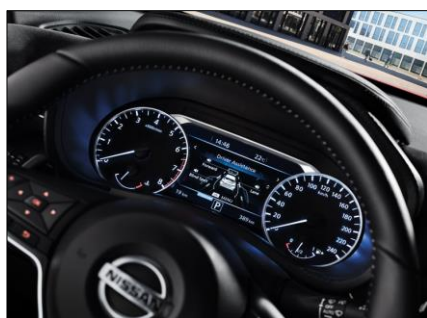
Улучшенный дисплей Advanced Drive Assist (ADAD) с диагональю 7,0 дюйма на панели инструментов
