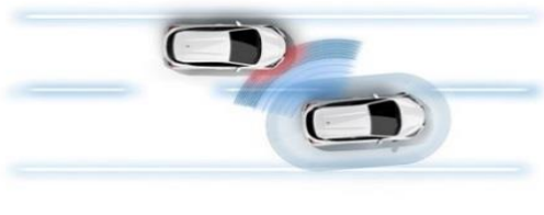
Предупреждение о помехе в слепой зоне обзора
