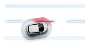
Интеллектуальная система контроля движения в центре полосы
