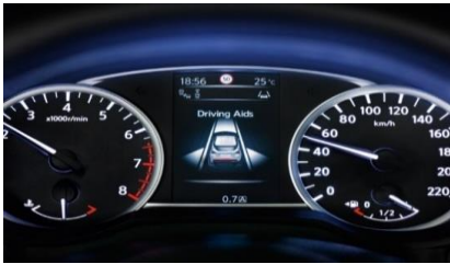
Комбинация приборов на TFT экране, 5 дюймов
