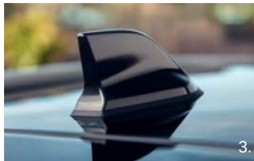
3. Haizivs spuras antena (82 01 731 020)
